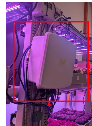
研究開発用の栽培ラックにAI灌水モニタリングユニットを設置
